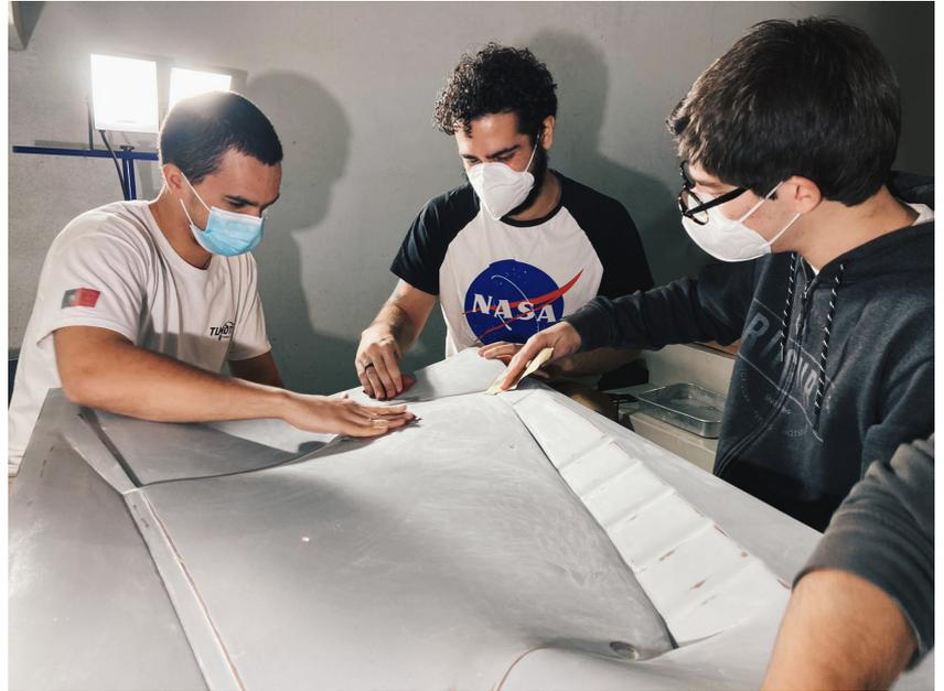
ao conhecimento da cola a utilizar, o que vai permitir diminuir o tempo quando for executado o mesmo processo nas carenagens principais de fibra de carbono. Foram ainda feitos reparos nos moldes em fibra de carbono para proceder às laminações das carenagens principais em fibra de carbono e também para o banco em monocoque.
